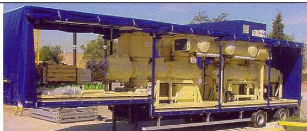
Carretón 132-66 kV en emplazamiento para ser utilizado
