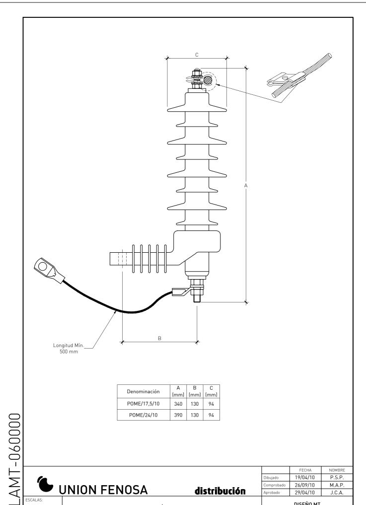
FECHA NOMBRE 19/04/10 P.S.P. Dibujado **UNION FENOSA** 26/09/10 M.A.P. Comprobado distribución Aprobado 29/04/10 J.C.A. ESCALAS: DISEÑO MT AUTOVÁLVULA SIN ALOH REV. 2 **ESCALA** Nº PLANO PROYECTO TIPO LÍNEAS ELÉCTRICAS AÉREAS LAMT-060000 C.O.E. Laboratorio Central Oficial de Electrotecnia.HA\$7/A02/0/kV
