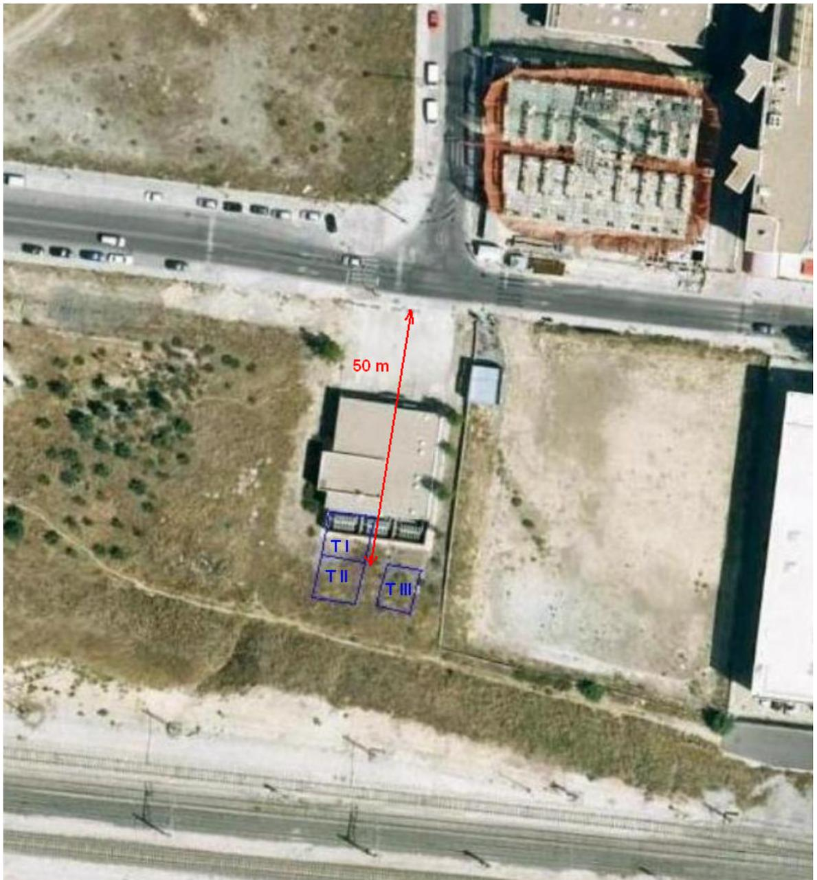
Por tanto, considerando que el NPS de los tres transformadores será de unos 80 dBA en la entrada de la subestación se percibirán 45 dBA.
