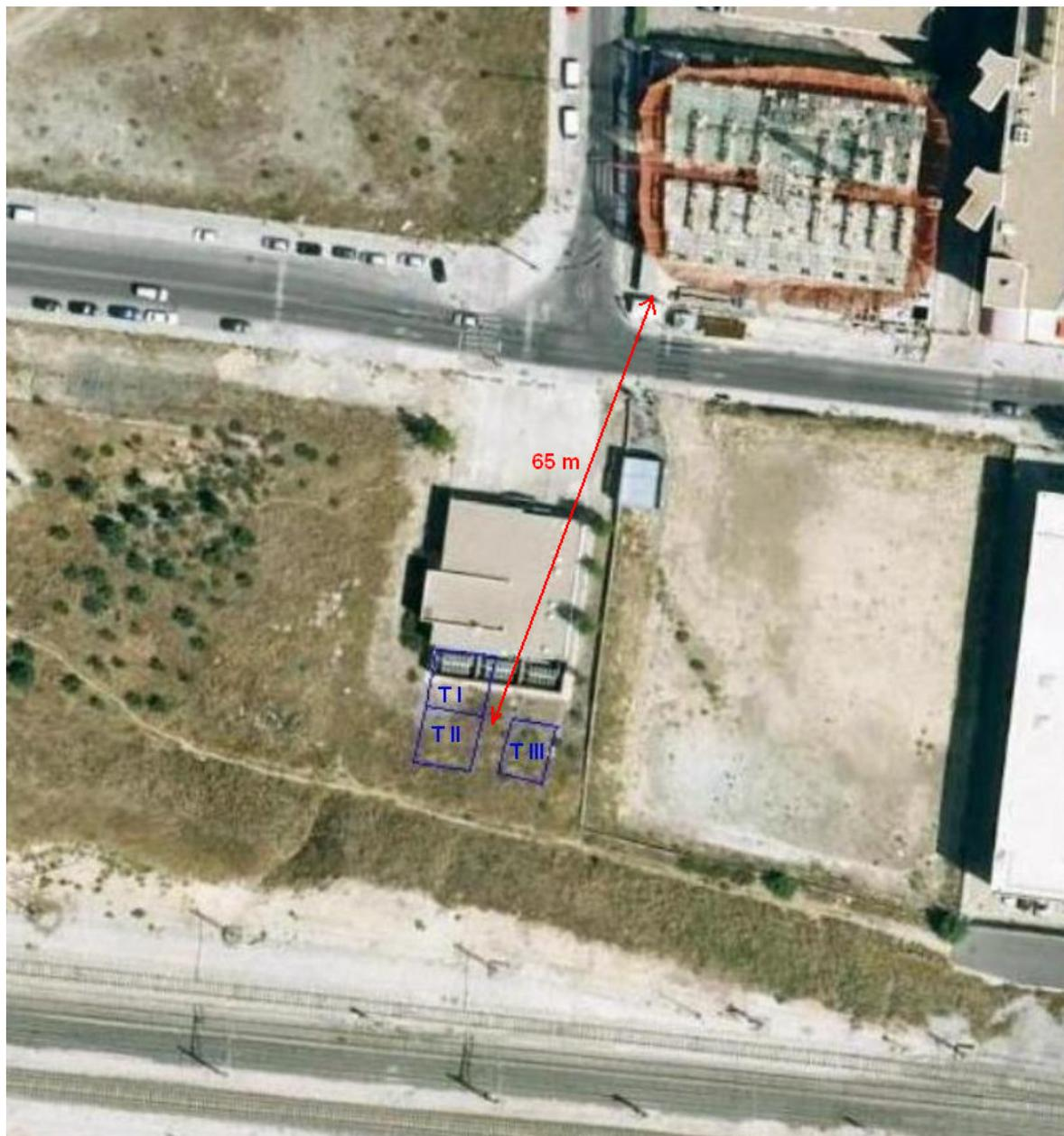
Por tanto, considerando que el NPS de los tres transformadores será de unos 80 dBA en la entrada de la subestación se percibirán 43,6 dBA.
