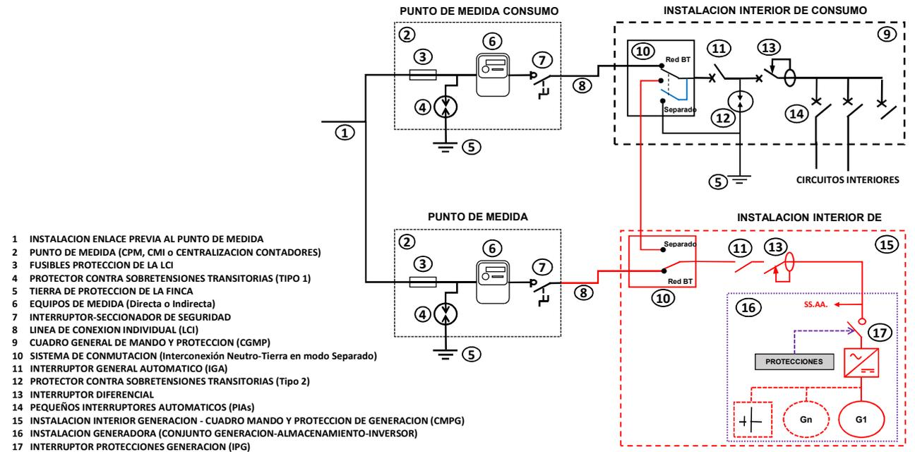
**FIGURA MS3 - CONMUTACION MODO SEPARADO EN AUTOCONSUMOS COLECTIVOS CON GENERACION CONECTADA EN INSTALACION DE ENLACE**
