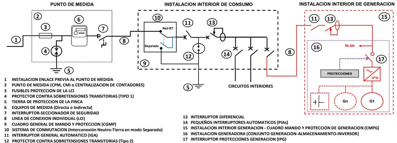
**FIGURA MS2 - CONMUTACION MODO SEPARADO EN AUTOCONSUMOS INDIVIDUALES CON GENERACION CONECTADA EN INSTALACION DE ENLACE**
