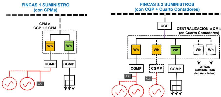
**CONFIGURACION "D1" (Individual en Instalación de Enlace)**
