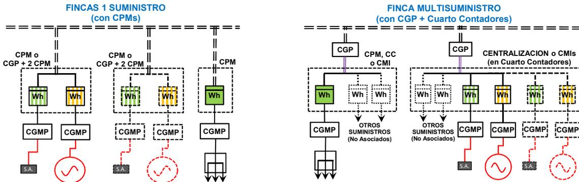
**CONFIGURACION "D3" (Individual Mixto: a través de Red de Distribución e Instalación de Enlace)**
