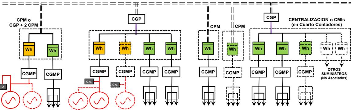
**CONFIGURACION "C1" (Individual en Instalación de Enlace)**
