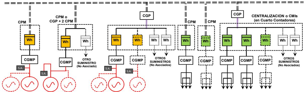
**CONFIGURACION "B6" (Colectivo Mixto: a través de Red de Distribución e Instalación de Enlace)**
