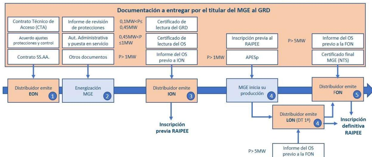
Figura 3 - Flujo de proceso de puesta en servicio de los MGE tipo B, C y D conectados a la RdD del sistema eléctrico peninsular.
