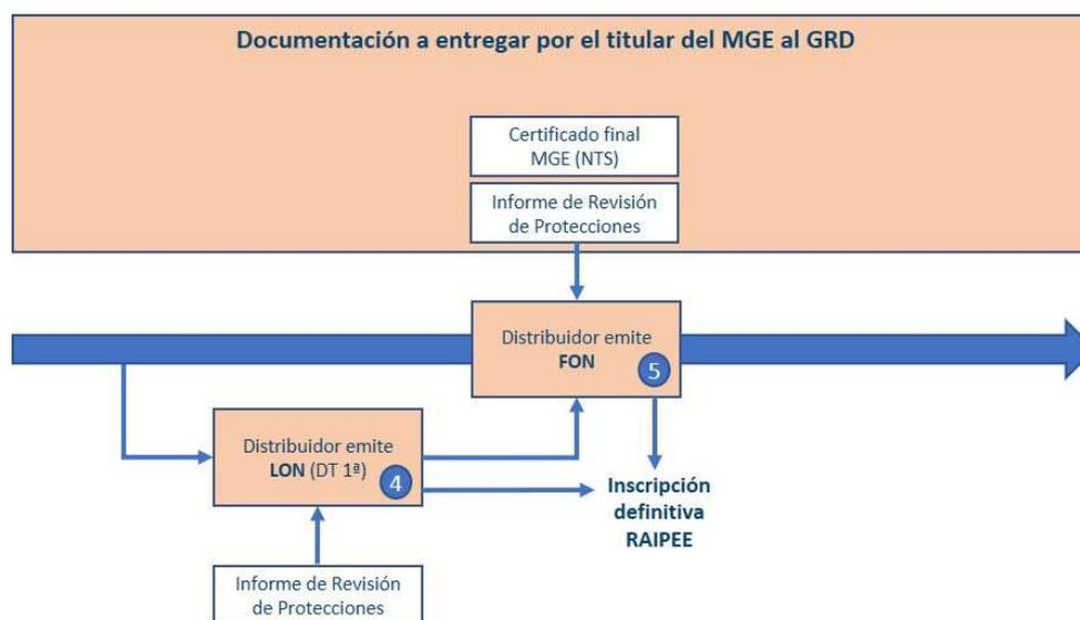
Figura 2 - Flujograma proceso de puesta en servicio de los MGE tipo A conectados a la RdD del sistema eléctrico peninsular.
