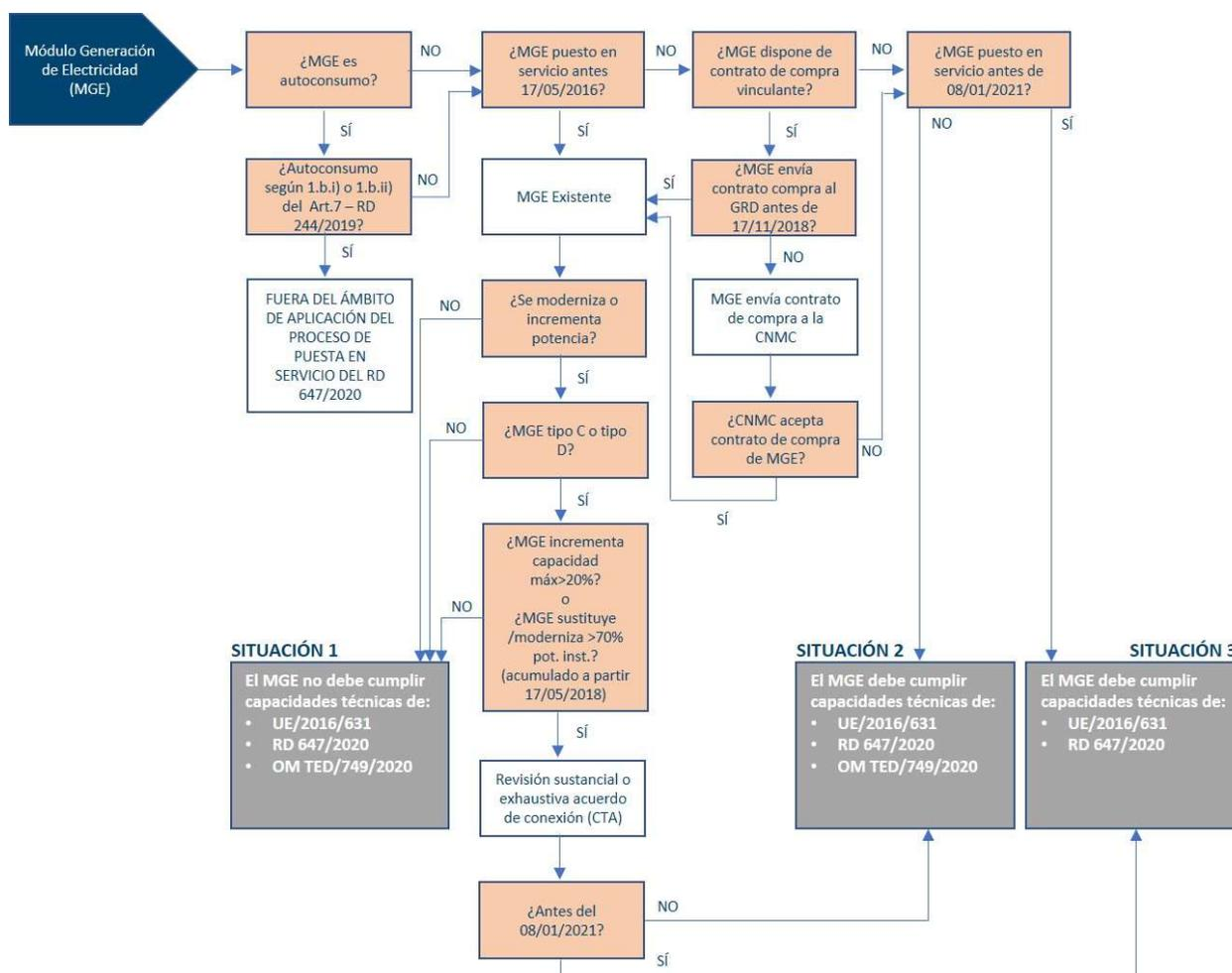
Figura 1 - Flujoograma – Condiciones para determinar las capacidades técnicas para los MGE conectados a la RdD del sistema eléctrico peninsular.
