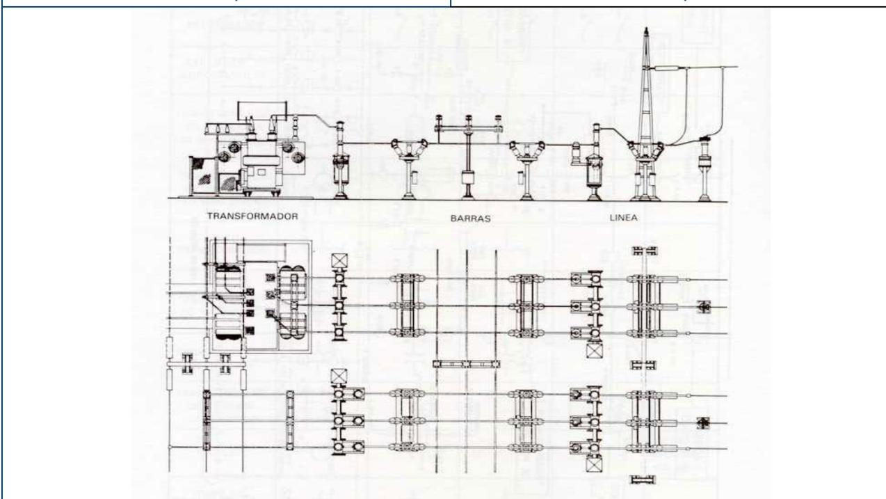
Vista en planta y alzado de una posición de transformador y de línea de un parque intemperie
