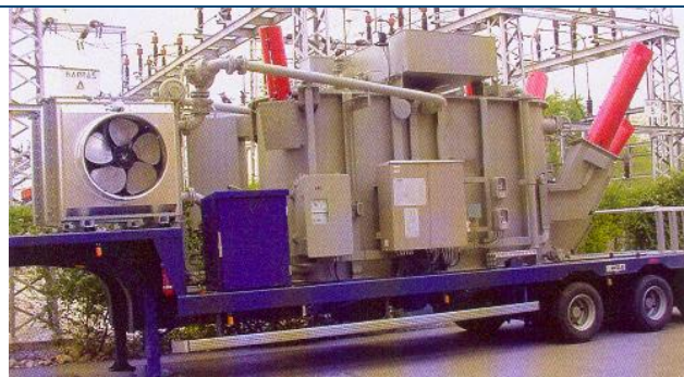
Disposición de transformador 132-66/20-15 kV listo para ser transportado
