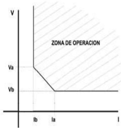
Figura 10. Ajuste protecciones MT neutro aislado.
